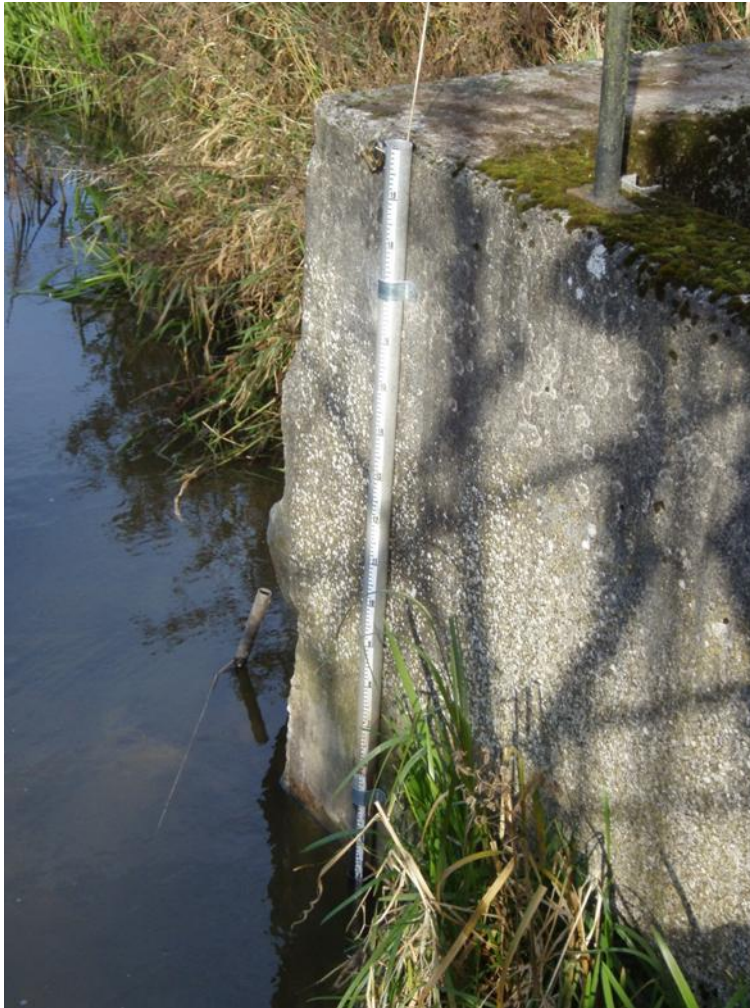
Bild 1. Bild på utplacerad tryckgivare i Tulltorpsån vid Jordeberga.
